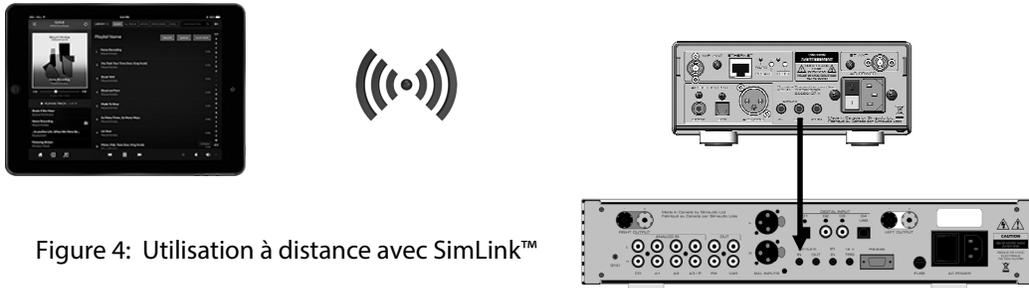
Figure 4: Utilisation à distance avec SimLink™
