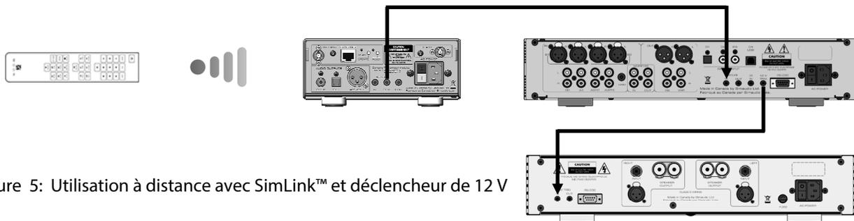
Figure 5: Utilisation à distance avec SimLink™ et déclencheur de 12 V
