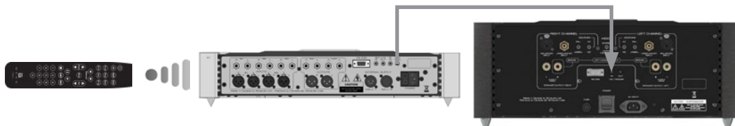
Figure 3 : commande à distance à déclencheur de 12 volts
