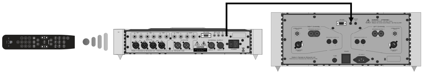
Figure 4: commande à distance à déclencheur de 12 volts
