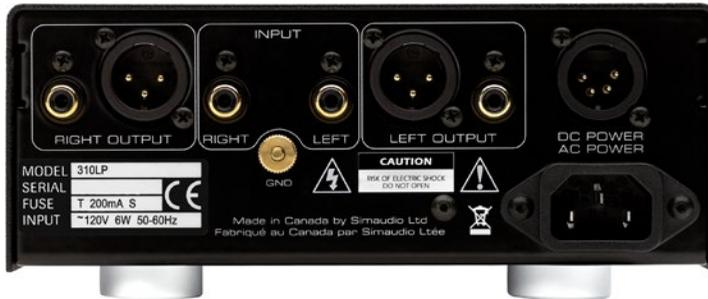
Le panneau arrière est semblable à celui de la Figure 10. Il y a une paire d'entrées RCA et une paire de sorties RCA ou XLR. Directement sous les entrées RCA, une borne de masse (Ground) est disponible. Connectez vos sorties de table tournante (sorties RCA) à ces connecteurs, sans oublier la borne de masse.
