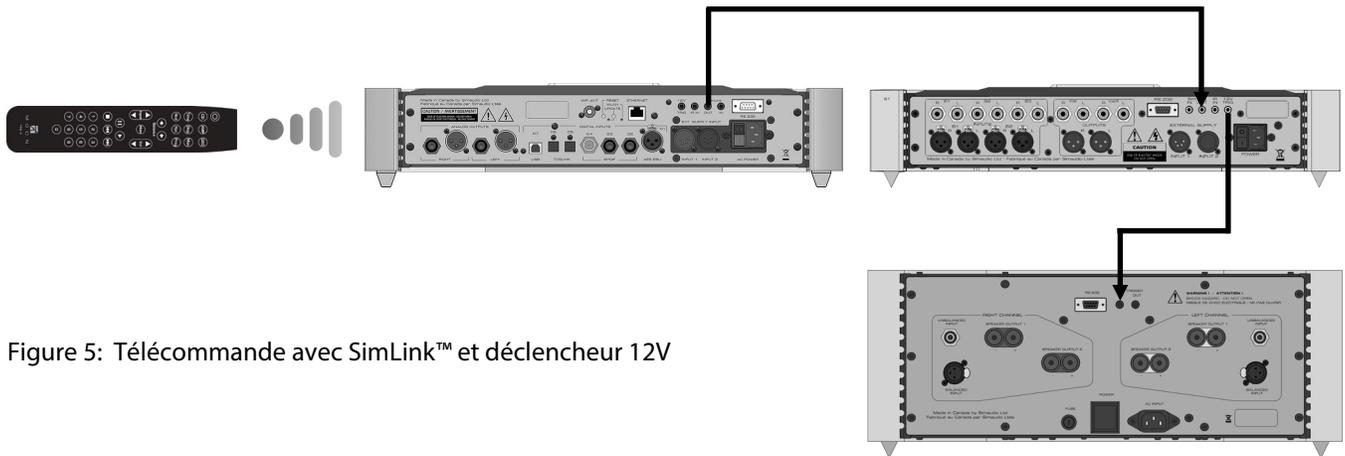
Figure 5: Télécommande avec SimLink™ et déclencheur 12V
