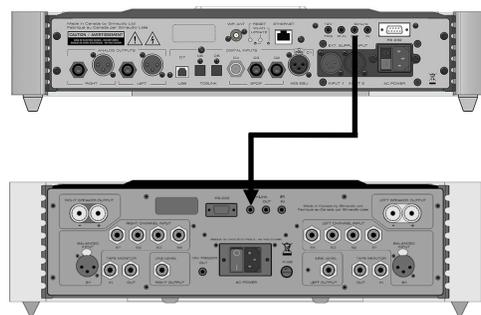
Figure 4: Contrôles à distance utilisant le SimLink™
