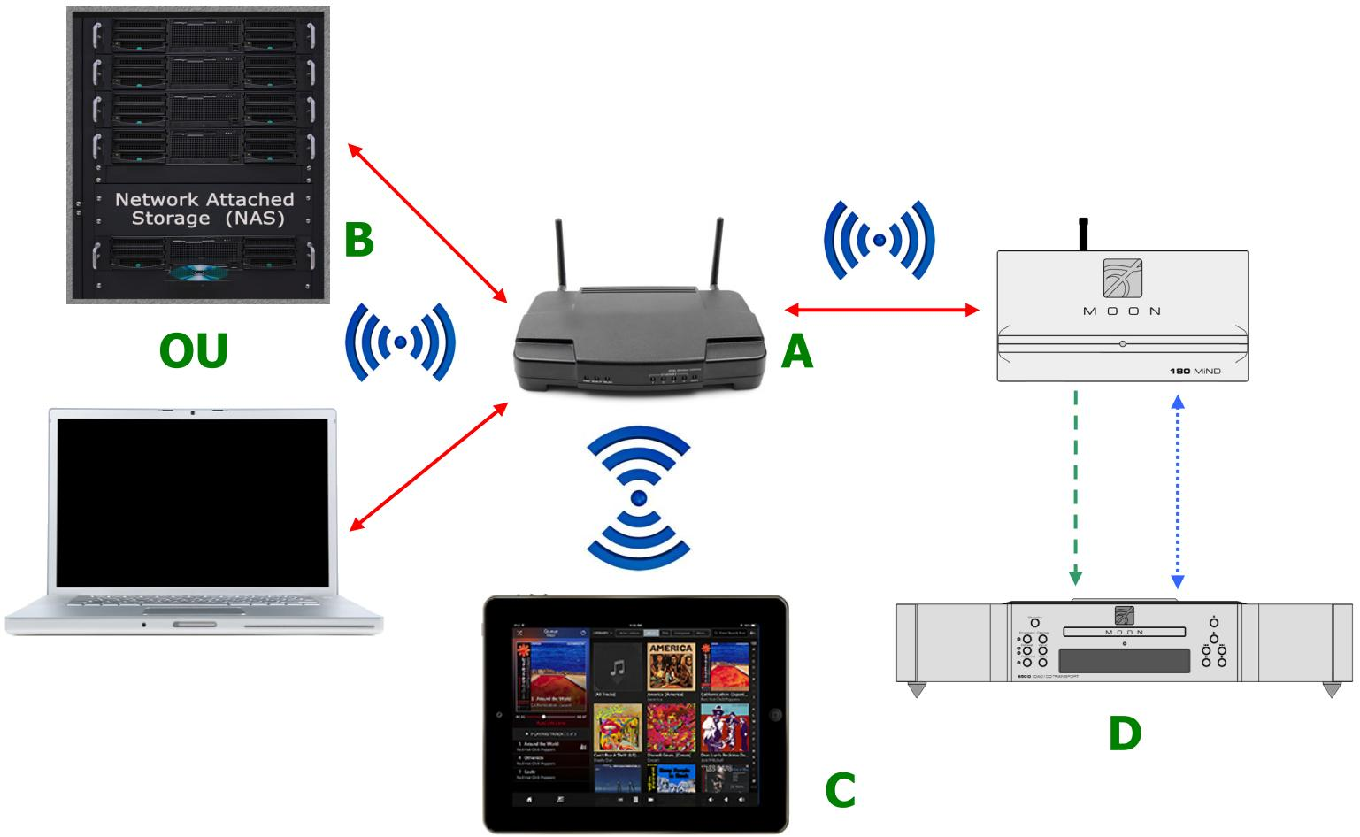
La figure ci-dessus montre les différents composants requis et la façon de les connecter pour utiliser le **180 MiND**:
