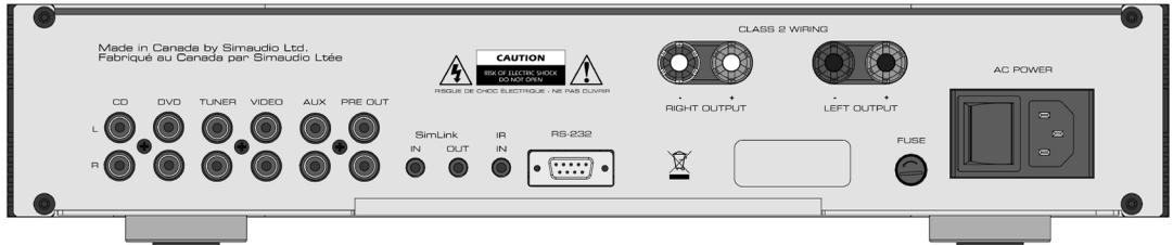
Le panneau arrière ressemble à celui de la figure 2 (Voir ci-dessus). Il possède cinq (5) paires de connecteurs RCA, repérées CD, DVD, Tuner, Vidéo et Aux. Les connections au canal gauche sont les prises RCA du dessus et les connections inférieures sont réservées au canal droit.
