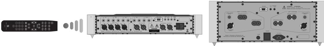
La figure 4 montre un préamplificateur 740P connecté à un amplificateur 870A par leurs déclencheurs de 12V respectifs. La sortie déclencheur 12V du 740P est connectée à l'entrée déclencheur 12V du 870A (en utilisant un câble mini connecteurs de 1/8"). Lorsque vous allumez le 740P à l'aide d'une télécommande, ou par le bouton « standby », le 870A s'allumera automatiquement. Cette règle s'applique aussi lorsque vous mettez le 740P en mode attente.
